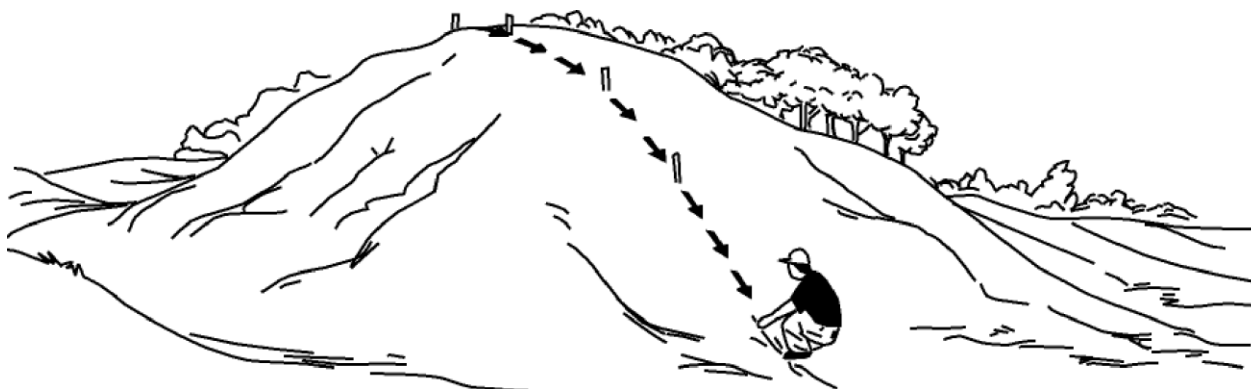
Figura 7. Trazo de línea madre en la medición de pendiente de un terreno.
