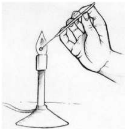
Figura 4: Esterilización del asa de siembra.
