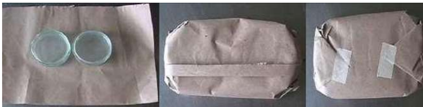
Figura 7: Pasos a realizar para preparar cajas de Petri para ser esterilizado por calor húmedo.
