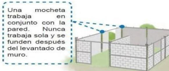
**Soleras:** Son elementos horizontales de concreto con refuerzo, trabajan en conjunto con la mampostería.
