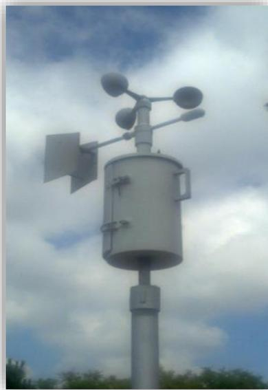
**Veleta registradora:** Indica la dirección del viento, lleva en un extremo un contrapeso terminado generalmente en punta de flecha, la cual apunta la dirección de donde viene el viento; en el otro extremo lleva dos paletas verticales que obligan a situarse al aparato en forma que la resistencia al flujo del aire sea mínima, esto es paralelamente a su dirección.
