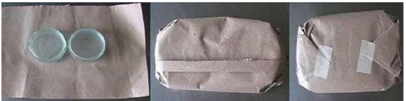
Figura 6: Pasos a realizar para preparar cajas de Petri para ser esterilizado por calor húmedo.
