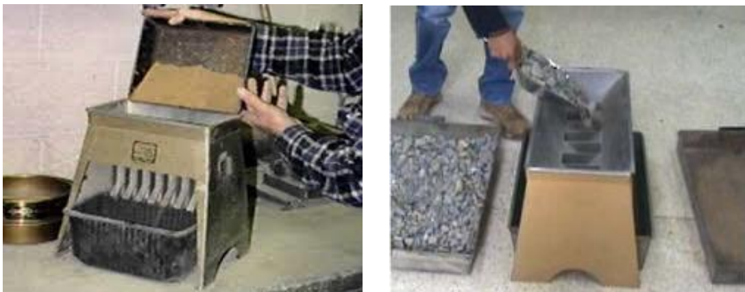
Imagen 25: Distribución del agregado en la canaleta alimentadora.
