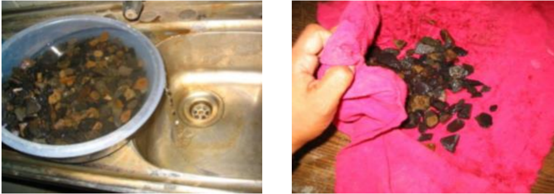
Imagen 35: Remoción y secado del agua superficial en la muestra.
