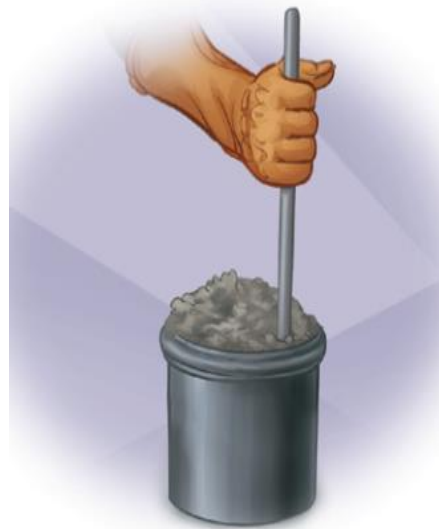
Imagen 19: Método de varillado para agregados según ASTM C29.
