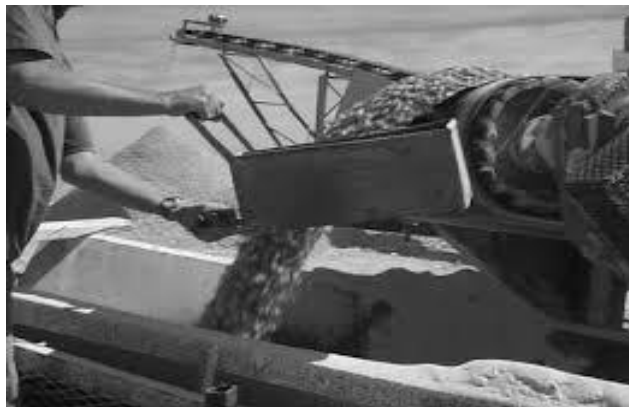
Imagen 20: Muestreo en un flujo de descarga.
