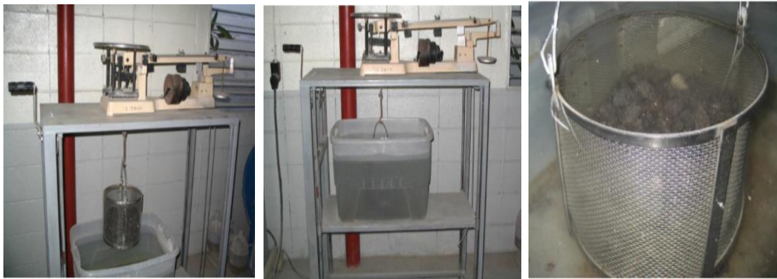
Imagen 36: Masa en condición sss y peso aparente de la muestra.
