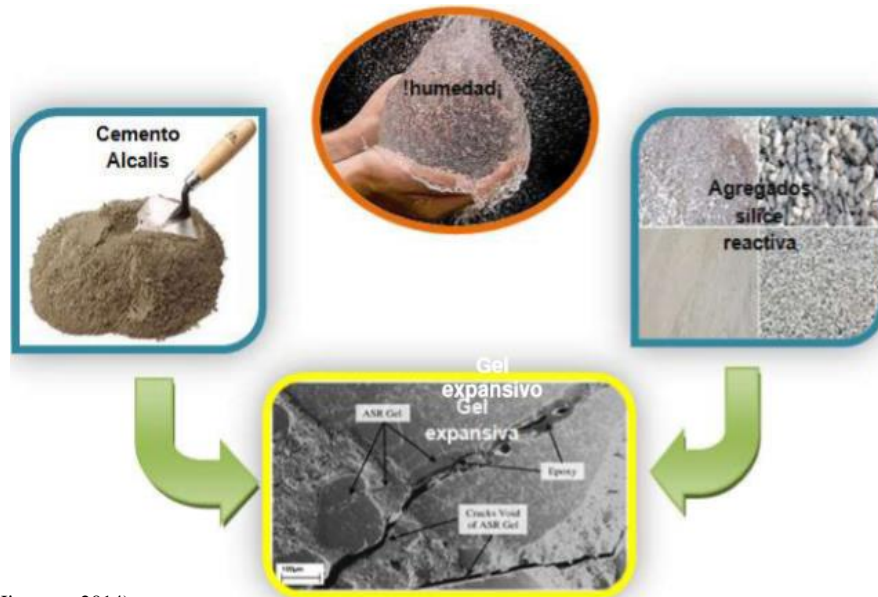
Imagen 44: Proceso de reacción álcali-agregado.
