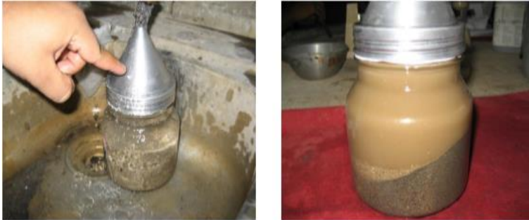
Imagen 32: Picnómetro con arena más agua.
