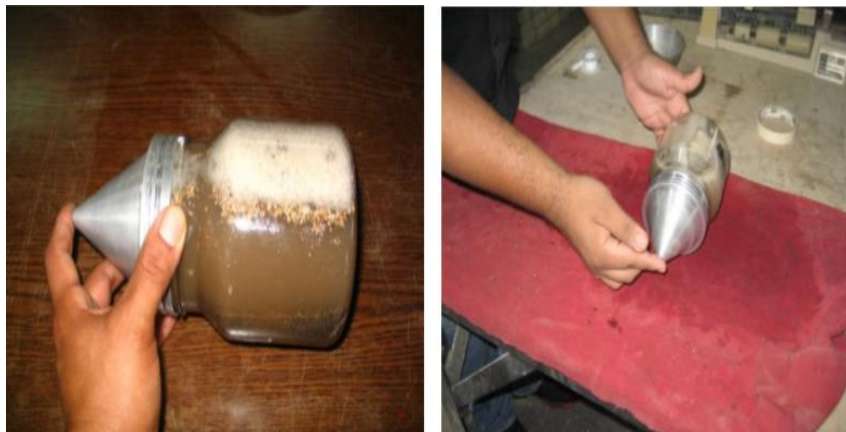
Imagen 33: Desairado de la muestra a través del agitado manual.
