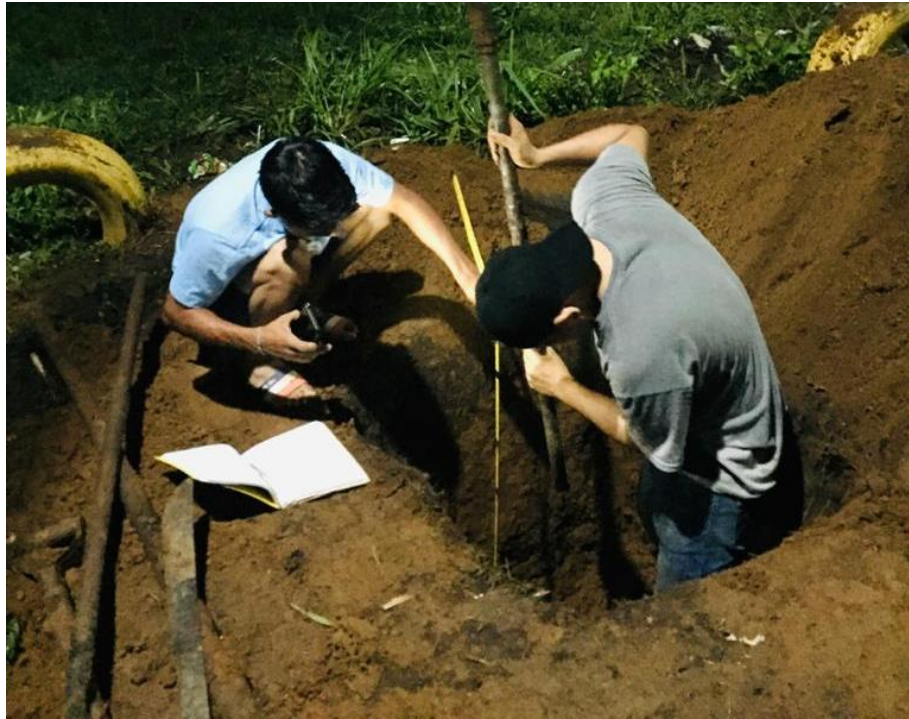
Figura 6: Verificación de suelo y cálculo de valor soporte por método de la barra.
