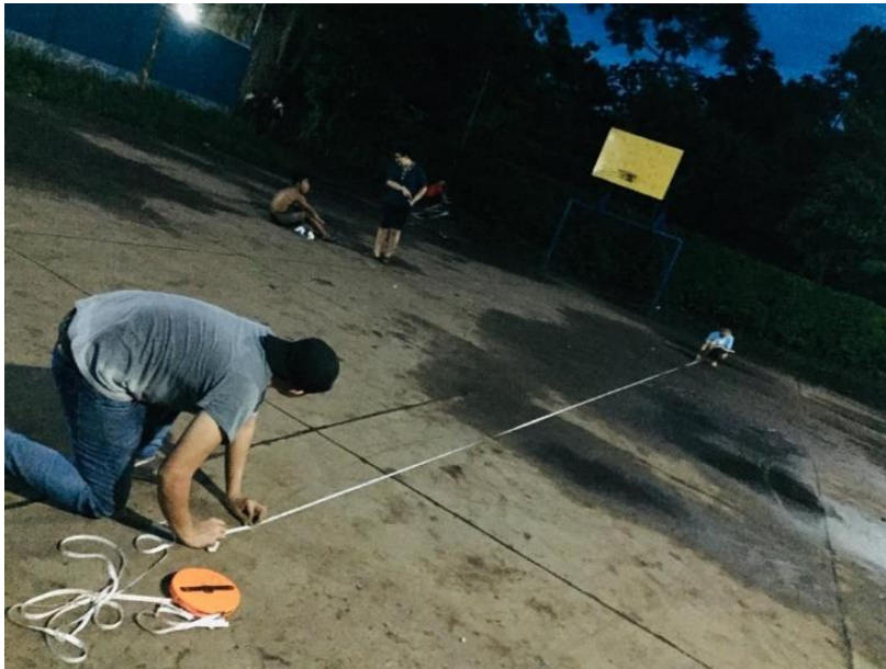
Figura 1: Medición topográfica, método de radiaciones, cinta métrica.
