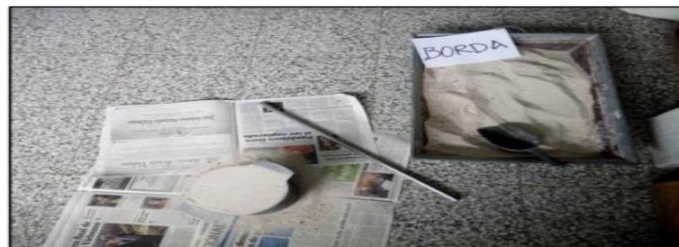
Figura N. 23 Ensayo de peso unitario agregado fino
