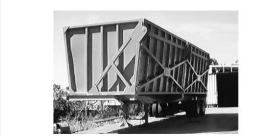
Figura 5. Jaula para transporte de caña de azúcar
