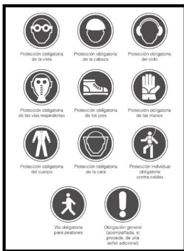
Figura No. 34: Ejemplo de señales de uso obligatorio de equipo de seguridad
