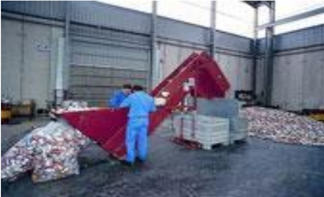
Figura 14. Banda transportadora para clasificar latas de aluminio
