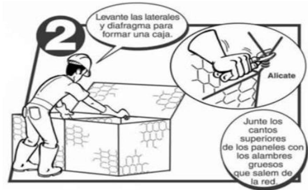
Figura 13. Levante las laterales y diafragma para forma una caja.
