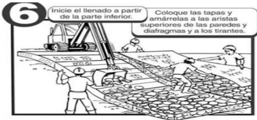
Figura 23. Índice el llenado a partir de la parte inferior, coloque las tapas y amárrelas a las aristas superiores de las paredes diafragmas y a los tirantes, ahora los colchones reno están listos.
