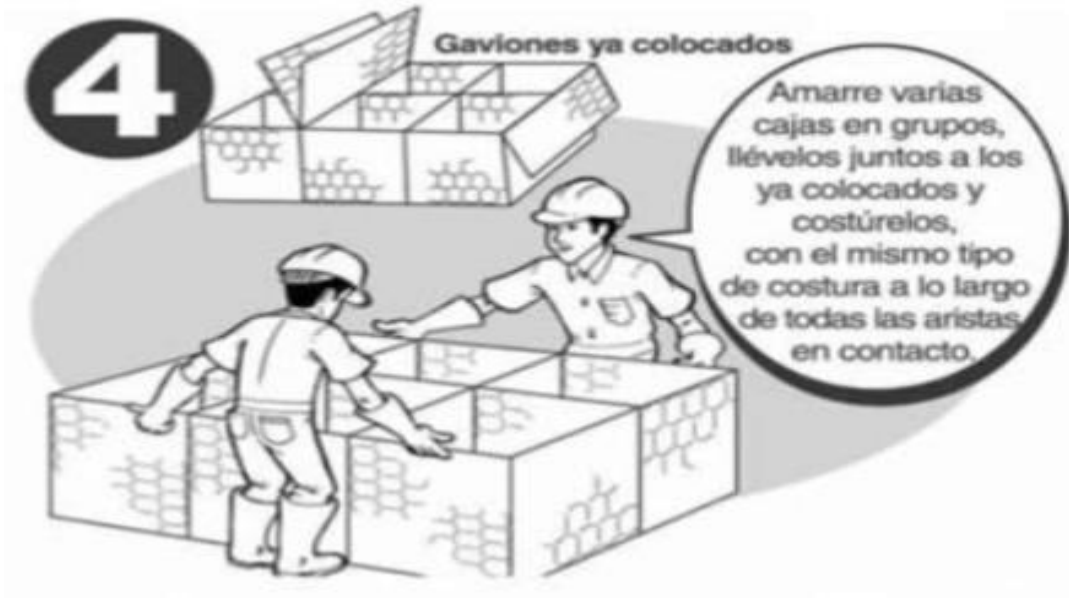
Figura 15. Cuando gaviones ya colocados, amarre varias cajas en grupos, llévelos juntos a los colados y costúrelos.
