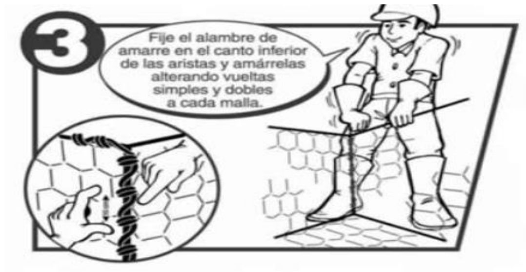
Figura 14. Fijar el alambre de amarre en el canto inferior de las aristas y amárrelas para alterar vueltas simples y dobles a cada malla.
