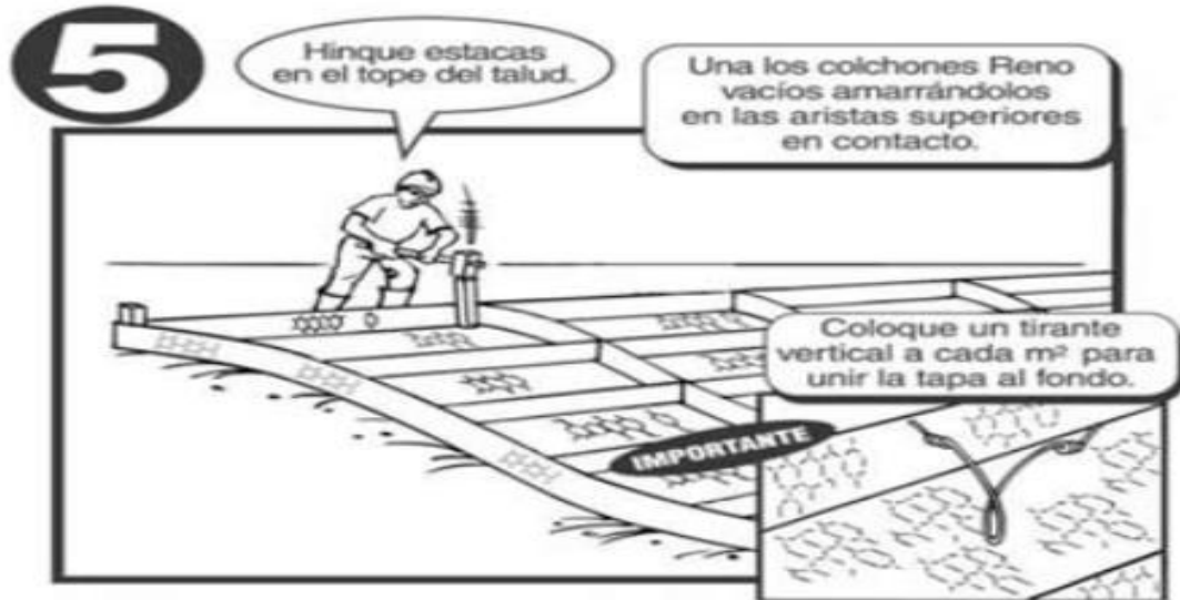
Figura 22. Hínque estacas en el tope del talud una los colchones reno vacíos amarrándolos en las aristas superiores en contacto.
