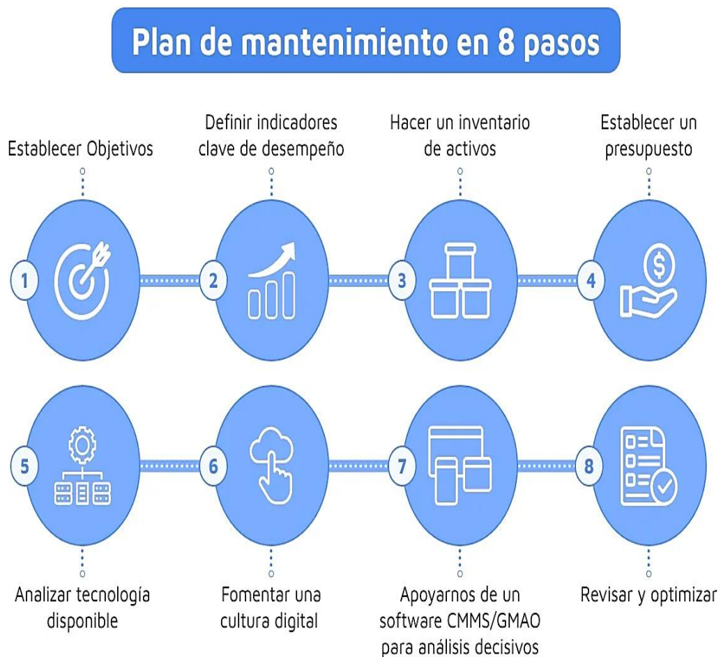
Figura 15. 8 pasos para realizar un mantenimiento
