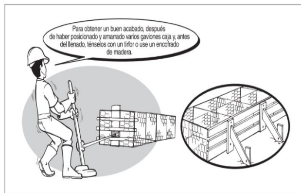
Figura. 19 Encoframiento de cajas de acero para gaviones
