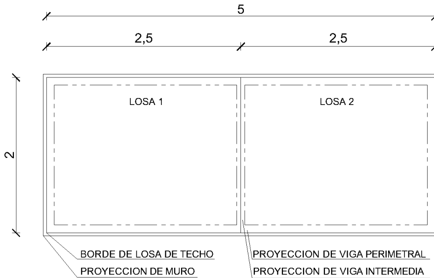
Figura 1. Planta de tanque de almacenamiento.
