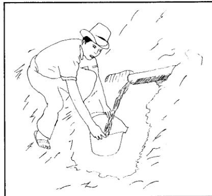
Figura 9: Aforo de agua por el método volumétrico
