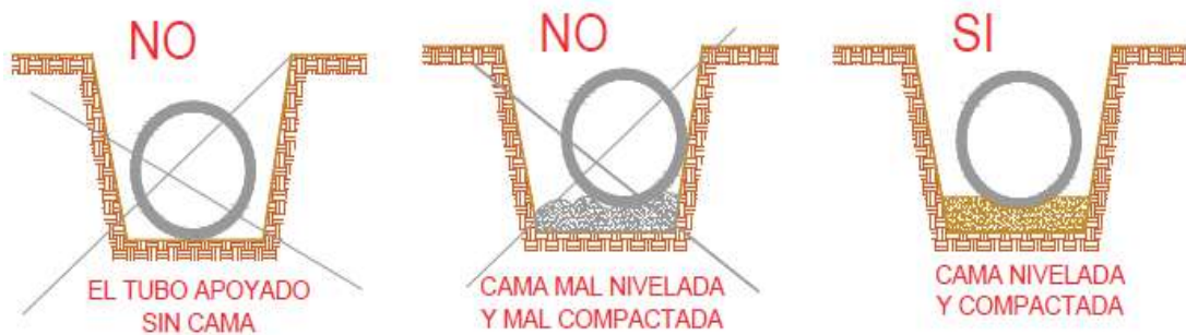
Figura 10. Construir una cama nivelada y bien compactada.
