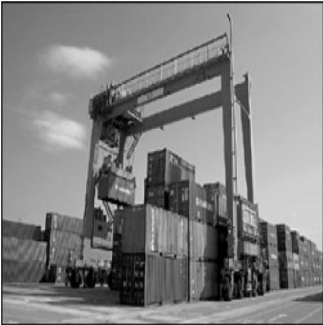
Figura 18. Grúa pórtico de patio
