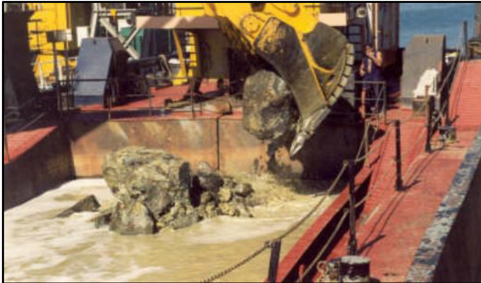
Figura 24. Gánguil de casco partido, descarga por gravedad
