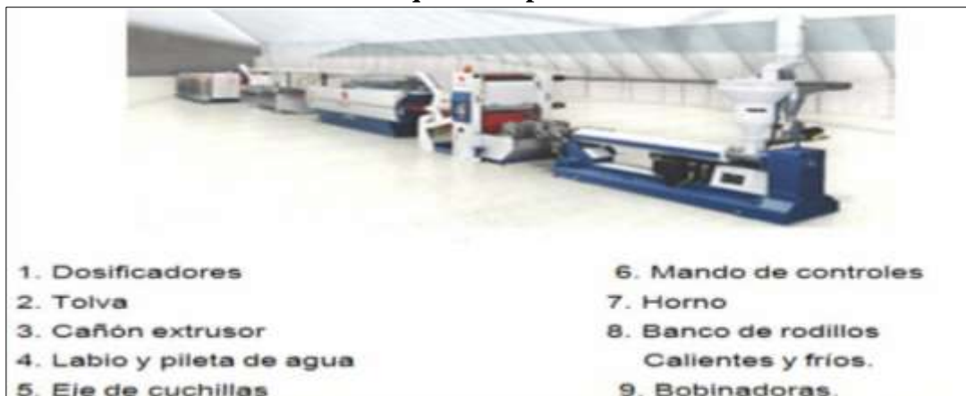
Ilustración 2. Máquina del proceso de extrusión.
