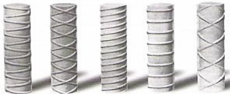
Tipos de corrugas en barras de acero para refuerzo
