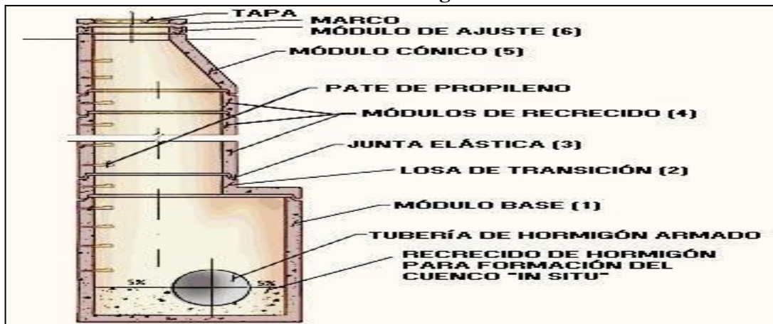
Ilustración 2. Pozo de registro o visita.
