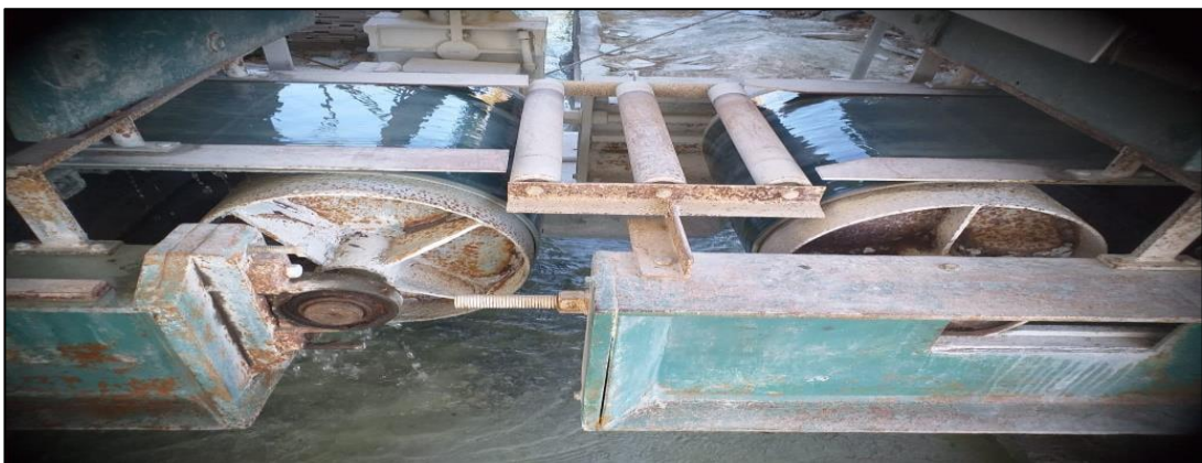
Figura 26. Faja transportadora de placas.
