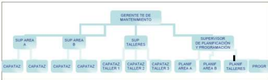
Diagrama 7: Organización de mantenimiento descentralizada (por áreas).
