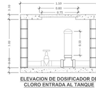
**ELEVACION DE DOSIFICADOR DE CLORO ENTRADA AL TANQUE**
