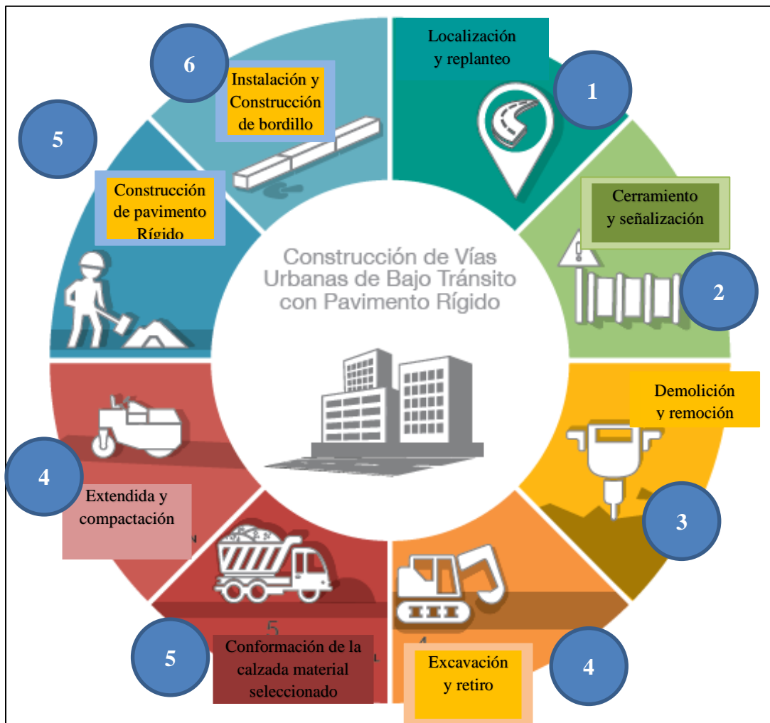
Figura 5. Fases del proceso constructivo.
