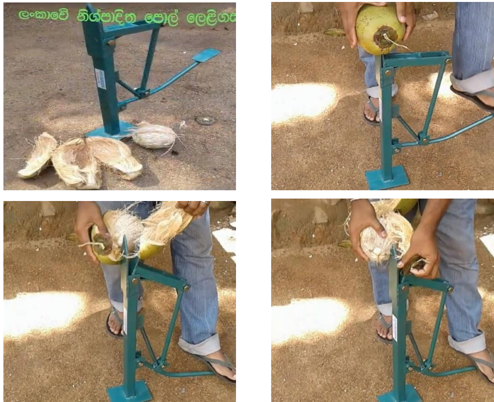
Fig. 2: peladora de cocos ( Cocos nucifera L.), Titmas y Hickish (1929)en su patente US1724739
