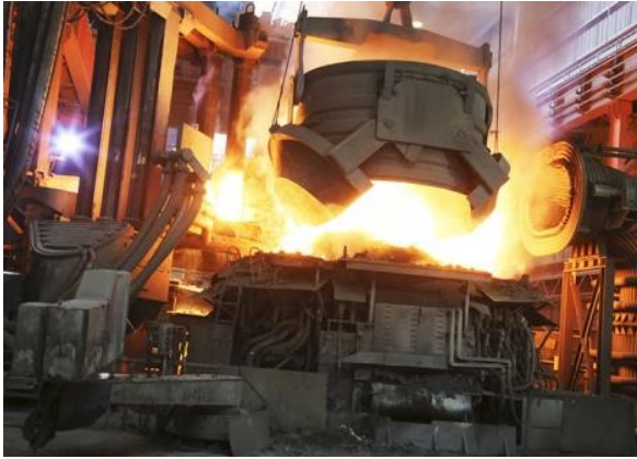
Ilustración 1: Fundición de chatarra en horno de arco eléctrico
