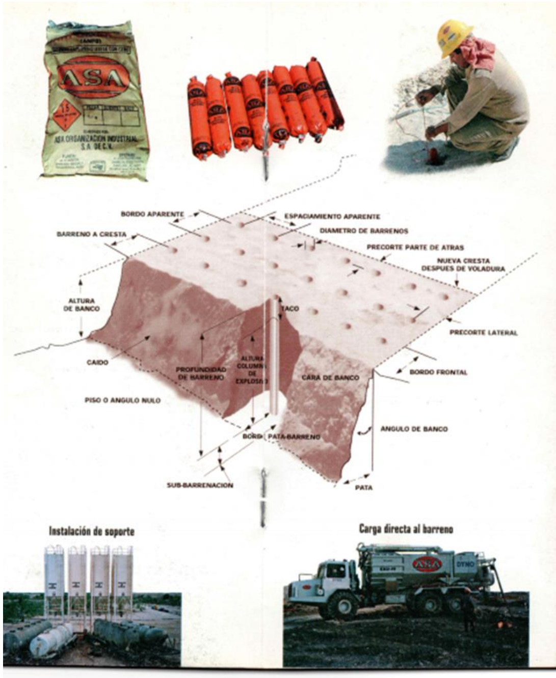
Imagen 18 Terminología de explosivos usada en el campo
