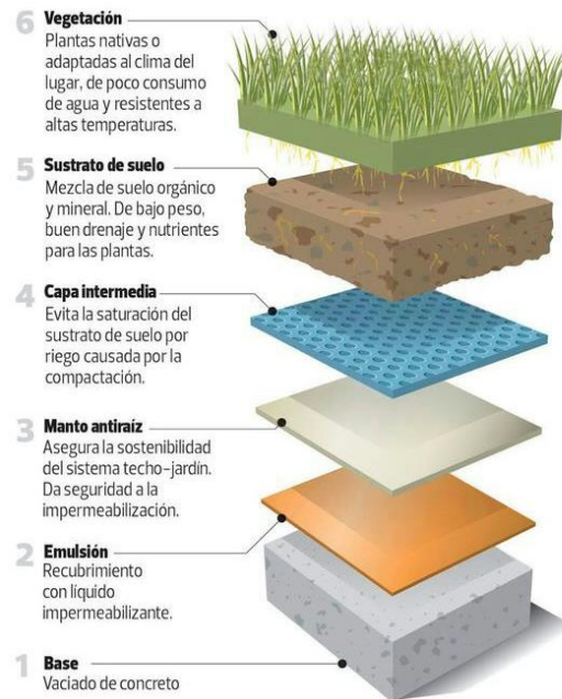
Imagen 44: Despliegue de capas en muro verde.
