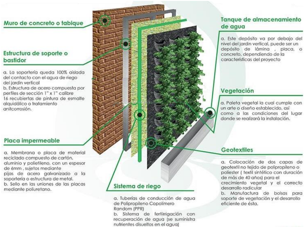
Imagen 45: Proceso constructivo de jardines verticales.
