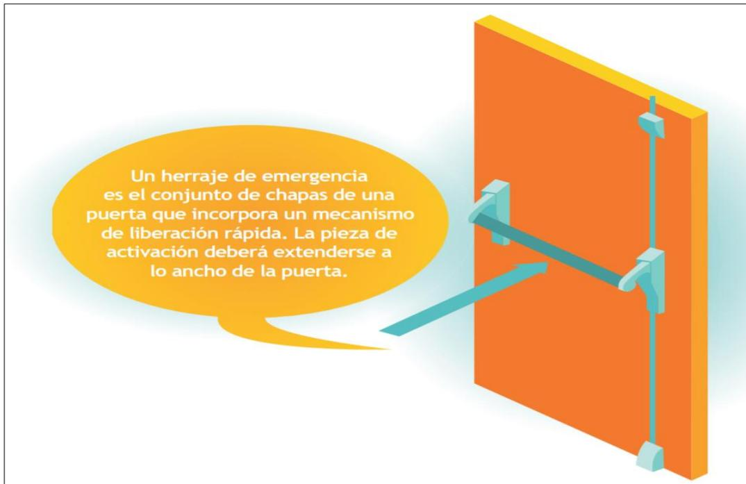
**Ilustración 8. Puerta correcta para salida de emergencia.**
