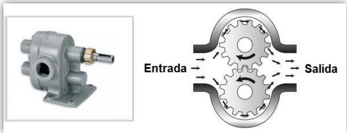
Figura 2. Bomba de engranajes. Esquema de funcionamiento
