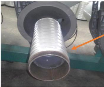
Como por ejemplo; a esta bobina solo le hace falta poco para ser cambiada. El operario debe de estar atento para ver cuál bobina camíbar antes de que se vacíe, ya que si esto sucede será muy complicado buscar el hilo a remplazar.
